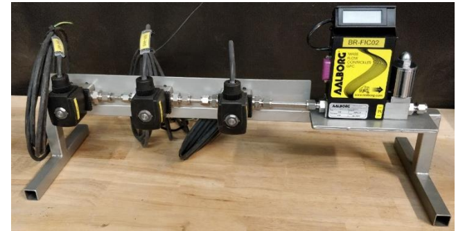
3x magneettiventtiilit (Burkert) ja massavirransäädin (Aalborg)
