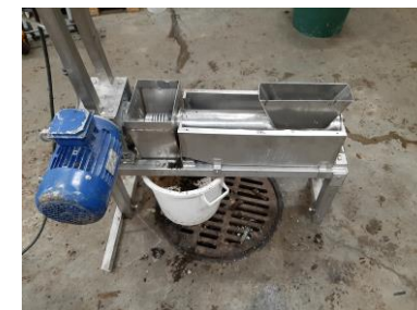
Neste-kiintoaine-erotusta on tehty mm. ruuvilla. Kuva: VTT
